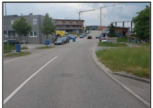
Maßnahme: Verengung der Fahrbahn sowie Aufpflasterung im Querungsbereich. Absenkung der Bordsteinkante.
