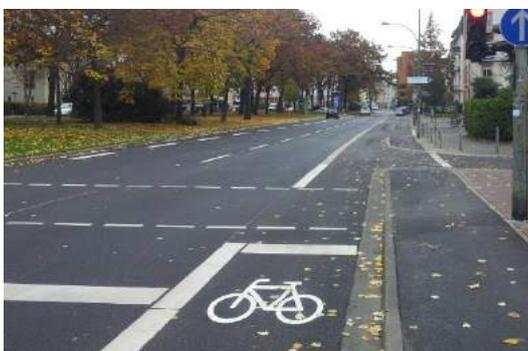
**Abbildung 2:** Beispiel einer vorgezogenen Haltelinie an einer Lichtsignalanlage (LSA)
